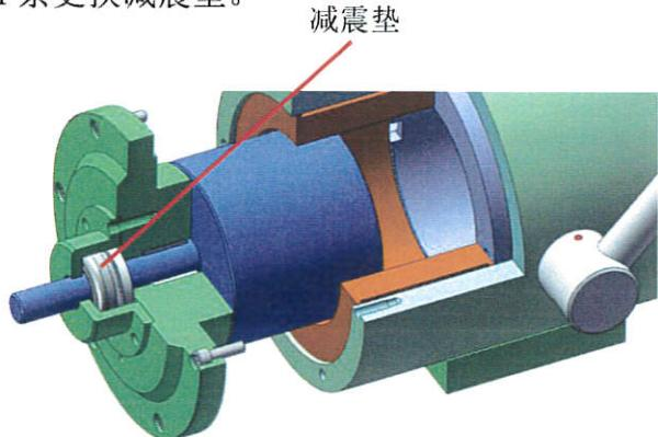
**注：1. 建议对长期存储的减震垫通风干燥常温存储，使用在温度>60℃，低温 <0℃，湿度>60%RH 的环境下的减震垫，2 年需排查确认或更换(特别是温度>75℃，湿度>75%RH 的环境下使用的减震垫)。**
