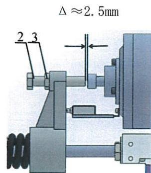
步骤 1: 手推动铁芯到最里侧, 调整制动螺栓使螺栓端面和动铁芯端面的间隙至 2.5mm (初始抱闸安装时调整) 左右。
