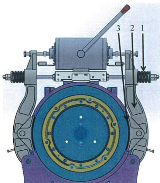
步骤 1: 将单侧的制动弹簧调节螺栓完全松脱。
