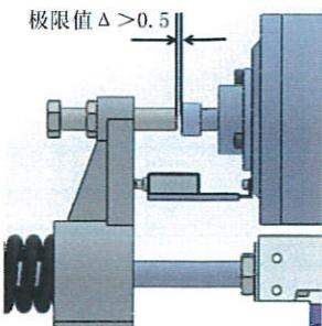
8. 当摩擦片厚度小于 4mm 时（制动轮径 495mm 以下的此值是 3mm），应及时更换闸瓦。
