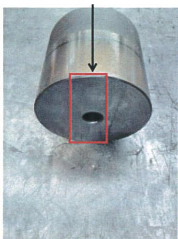
步骤 5：检查动铁芯端部与松闸杆接触而产生的划痕情况，划痕若高出表面，须修正平整。
