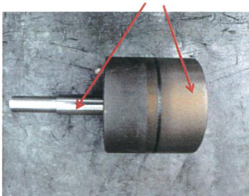
步骤 6：完成以上步骤后，在装回前动芯支撑部位均匀涂耐高温润滑脂（推荐品牌：CRC 的 SL3145/SL3330 润滑脂、长城的 HP-R 润滑脂、壳牌的 S5 T460 润滑脂，建议优选 SL3330 润滑脂）
